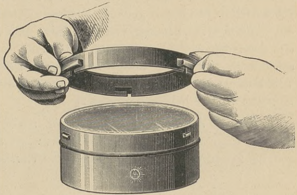
Fig. 9. Auseinandernehmen des durch Bajonettverschluß verbundenen Kondensors.
