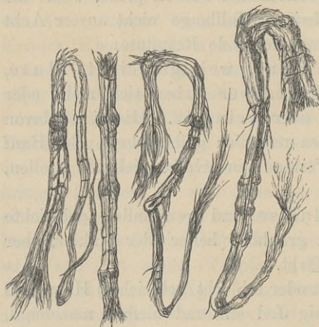
Fig. 75. Aus Leinenhadernpapier. Zerstörte, an den Enden in Fibrillen aufgelöste Flachsbastfasern aus einem Briefpapier.
