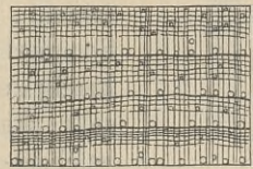
Fig. 127. Carya sp. Hickorybaum. Querschnitt, Lupenbild. Porenring sehr schmal, mit sehr grossen Poren in einer Reihe, im Sommerholz sehr kleine Poren und zahlreiche feine tangential laufende Linien von Holzparenchym.
