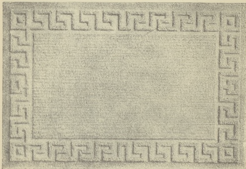
Fig. 97. — Panneau moulé et traité à l'acide.
