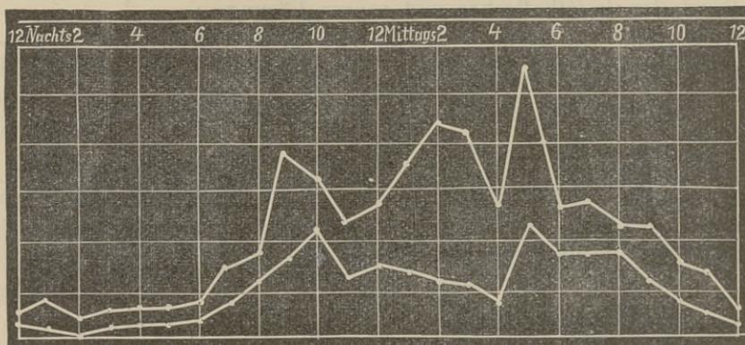
Die Entnahme des Schmutzwassers fand fortlaufend nach und nach von Morgens um 6 Uhr bis Nachmittags um 2 Uhr statt. Die Entnahme des geklärten Schmutzwassers fand 2—3 $\frac{1}{2}$ —4 $\frac{1}{2}$  Stunde später statt, wenn das Schmutzwasser, von dem ein Theil zur Untersuchung entnommen war, die Anlage passirt haben musste. Die Geschwindigkeit des Wassers in dem Becken wurde aus der Menge und Geschwindigkeit des zufließenden Schmutzwassers annähernd berechnet.
