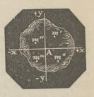
Achse AY im 3ten und 4ten Quadranten alle negativ. Dadurch kann dann aber der Fall eintreten, dass die Composante X=0 und zugleich auch Y=0, mithin auch F=0 wird, und folglich der Drehpunct A gar keinen Druck auszuhalten hat, weil sich in diesem Falle immer zwei gleiche entgegengesetzte Fliehkräfte tilgen.
