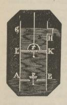
Er tauchte das untere, mit einem sich nach innen öffnenden Ventil versehene Ende eines Cylinders in das zu hebende Wasser. Wurde nun der anfangs unten bei AB befindliche und gleichfalls mit einem sich nach aussen öffnenden Ventil versehene Kolben LK in die Höhe gezogen, "so müsste ja ein leerer Raum unter dem Kolben entstehen, wenn die Natur nicht einen Abscheu stösst also das Ventil v auf und treibt das Wasser bis unter den Kolben LK in
