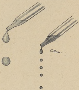
Abb. 33. Wassertropfen, die aus der gleichen Röhre wie Alkoholtropfen fallen, sind größer.
