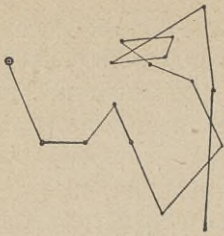
Abb. 23. Kinematographische Aufnahme der Brownschen Bewegung bei Kautschukmilchkügelchen.
