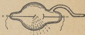
Abb. 37. Die Entstehung der Röntgenstrahlen. Die Abbildung stellt die einfachste Form einer luftleeren Röntgenröhre (X Strahlenröhre) dar. Der Elektronenstrom geht von der hohlspiegelartig geformten, mit — bezeichneten Platte (der Kathode) in der Röhre aus, die mit dem Konduktor der Elektrifiziermaschine verbunden ist. Die Elektronen saufen hinüber auf die mit der Erde verbundene schräg gestellte + Platte (die Anode), werden durch den heftigen Anprall plötzlich angehalten und erzeugen dadurch vermutlich eine Art Aufspritzen im Äther, das ganz kleine Wellen zur Folge hat, die durch die Strahlen angedeutet sind. Diese Wellen nennen wir Röntgenstrahlen; sie sind unsichtbar und durchdringen alle Stoffe mehr oder minder gut.
