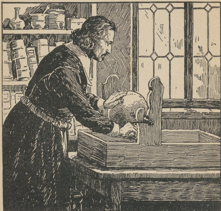
Abb. 4. Die erste Elektrifiziermaschine, eine Schwefelkugel, die durch die aufgelegte Hand bei der Drehung geladen wurde, und die sich dabei durch die der Hand entzogenen Elektronen mit Elektrizität anreicherte, d. h. negativ elektrisch wurde.
