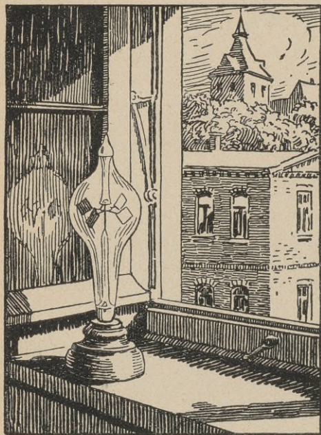
Abb. 19. Radiometer (Lichtmühle, dessen Bewegung man zur Erklärung der in Abb. 17 dargestellten Raddrehung durch Elektronen herangezogen hat.
