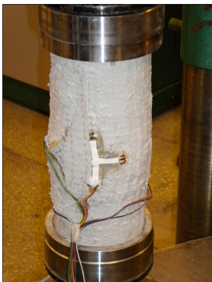
Ryc. 10. Obraz zniszczenia elementów ściskanych wzmocnionych siatką z włókien PBO na zaprawie mineralnej (dwie warstwy siatki PBO – z lewej, trzy warstwy siatki PBO – z prawej); fot. autorzy.
