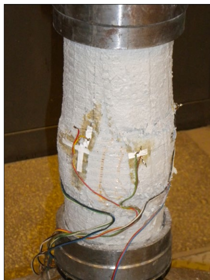
Ryc. 10. Obraz zniszczenia elementów ściskanych wzmocnionych siatką z włókien PBO na zaprawie mineralnej (dwie warstwy siatki PBO – z lewej, trzy warstwy siatki PBO – z prawej); fot. autorzy.
