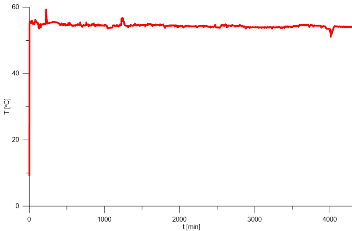
Rys. 37. Temperatura wlotowa cieczy do wymiennika – warunek brzegowy modelu CFD
