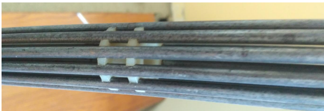
Fot. 38. Widok typowej wiązki drutów tworzących kabel sprężający 12Ø5 mm.
