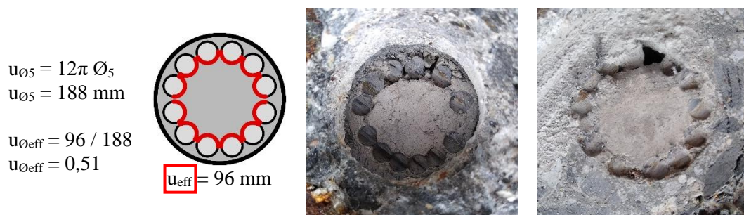
Rys. 122. Efektywny obwód kontaktowy dla dobrej jakości iniekcji (np. element B 1-2).
