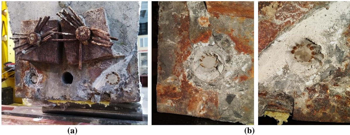
Fot. 28. a) Czoło belki B 1-2 przed badaniem, b) poślizg kabli sprężających wraz z iniekcją cementową.
