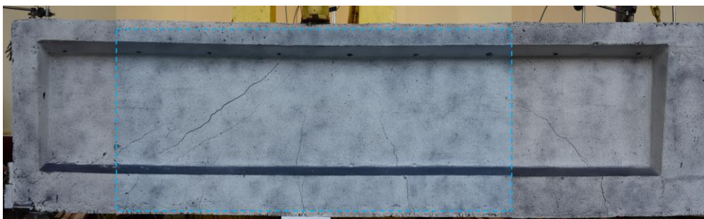
Fot. 21. Stan zarysowań belki B 1-0 przy działaniu obciążenia 990 kN.
