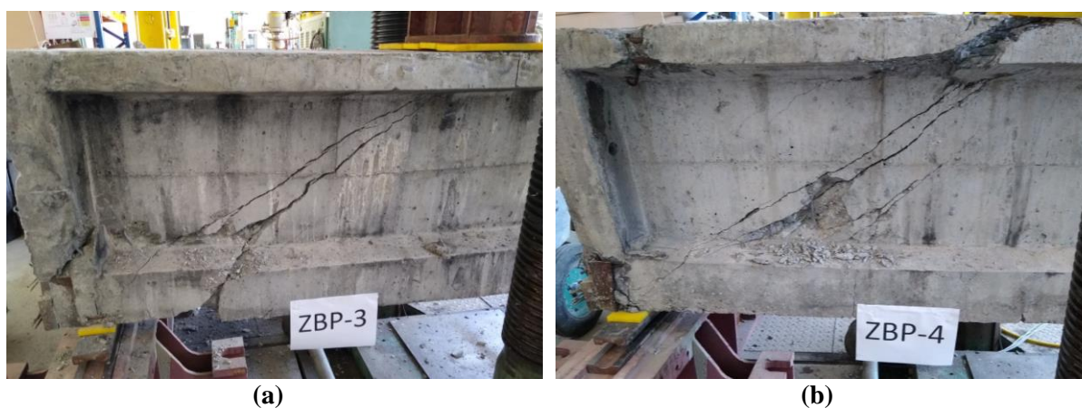
Fot. 25. Zniszczony ściskany krzyżulec betonowy – badanie a) B 1-1a; b) B 1-1b.
