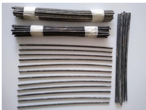
Fot. 53. Widok próbek drutów \varnothing 5 tworzących kable sprężające.
