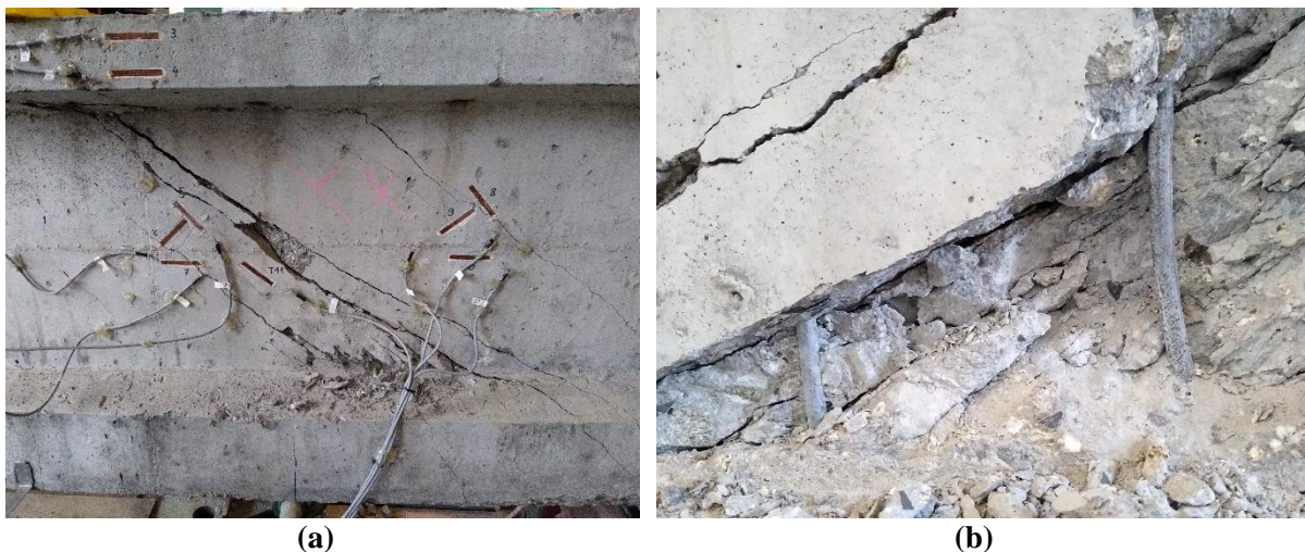
Fot. 27. a) Widok krzyżulca i towarzyszących rys prostopadłych, b) strzemiona w rejonie zmiażdżonego krzyżulca – badanie B 1-1b.
