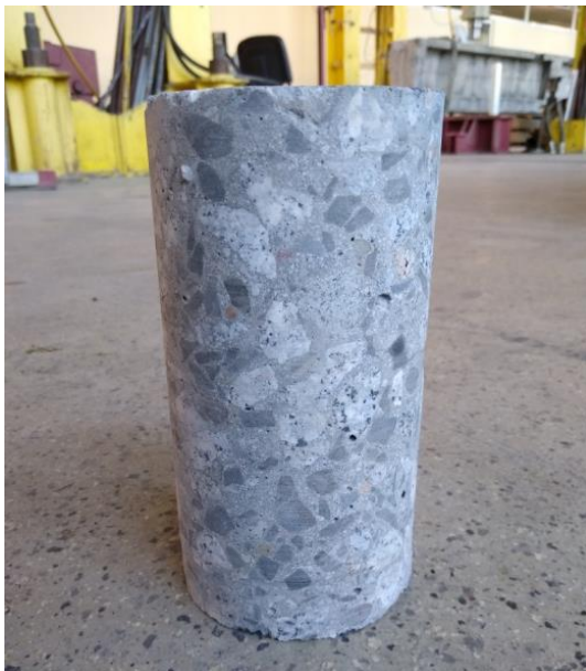
Fot. 56. Widok próbki betonowej przygotowanej do badania – walec \text{Ø}100 mm.
