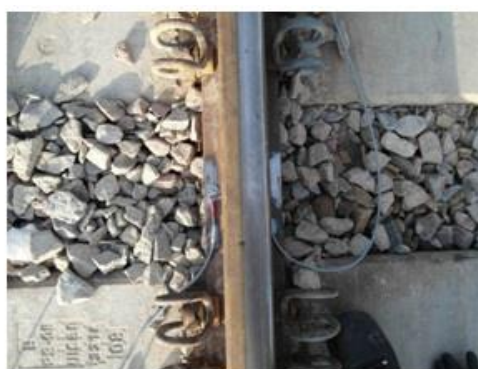
Rys. 4.2.3. Tensometr na stopce szyny. Źródło: Czyczuła i wsp. [31]
