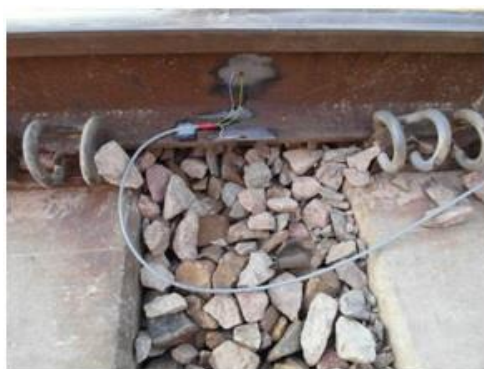
Rys. 4.2.2. Tensometr w osi obojętnej szyny. Źródło: Czyczuła i wsp. [31]
