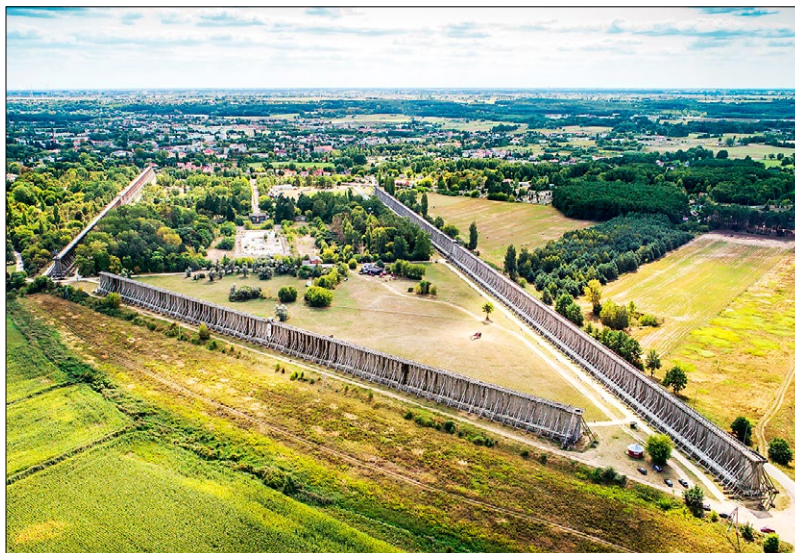
Ryc. 2. Krajobraz przy tężniach ustawionych dłuższymi osiami poprzecznie do dominujących kierunków wiatrów; źródło: archiwum WUOZ w Toruniu
