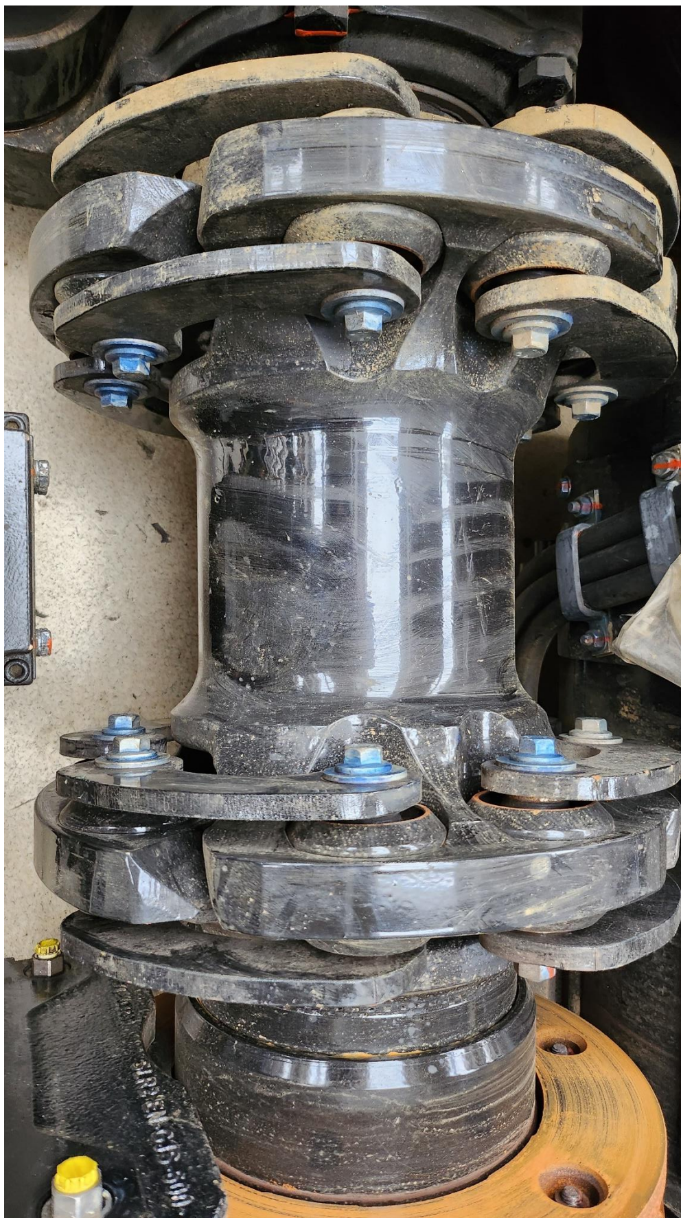
Rys. 1.4. Fotografia sprzęgła 4-cięgłowego - mechanizm w stanie złożonym
