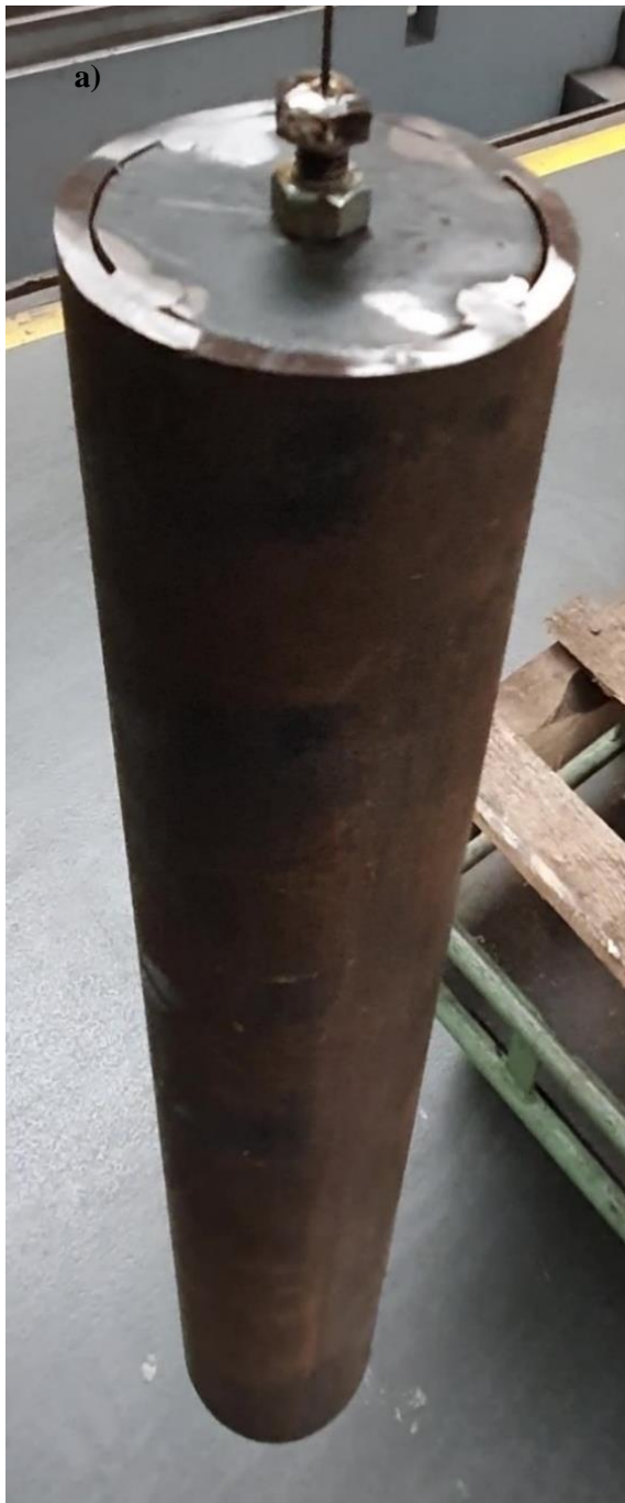
Rys. 3.11. Doświadczalne wyznaczenie masowego momentu bezwładności: a) dla rury badawczej, b) dla środkowej części sprzęgła, c) dla tarczy zabierakowej sprzęgła od strony wału napędowego wychodzącego od przekładni
