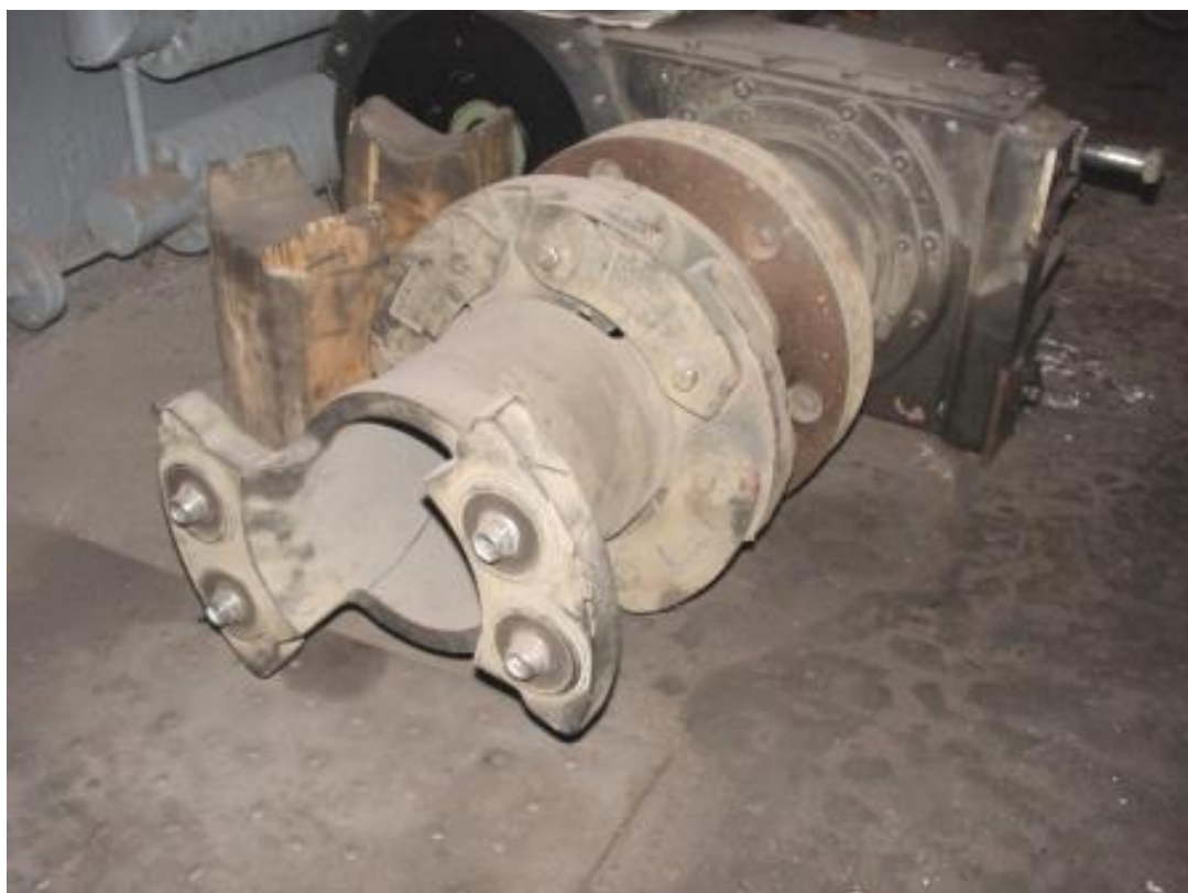
Rys. 1.6. Fotografia fragmentu układu napędowego ze sprzęgłem 4-cięgłowym; kolejno od tyłu: skrzynia przekładniowa, wał drążony wraz z tarczą hamulca postojowego, sprzęgło 4-cięgłowe z widocznym wałem pośrednim i tarczą zabieraka
