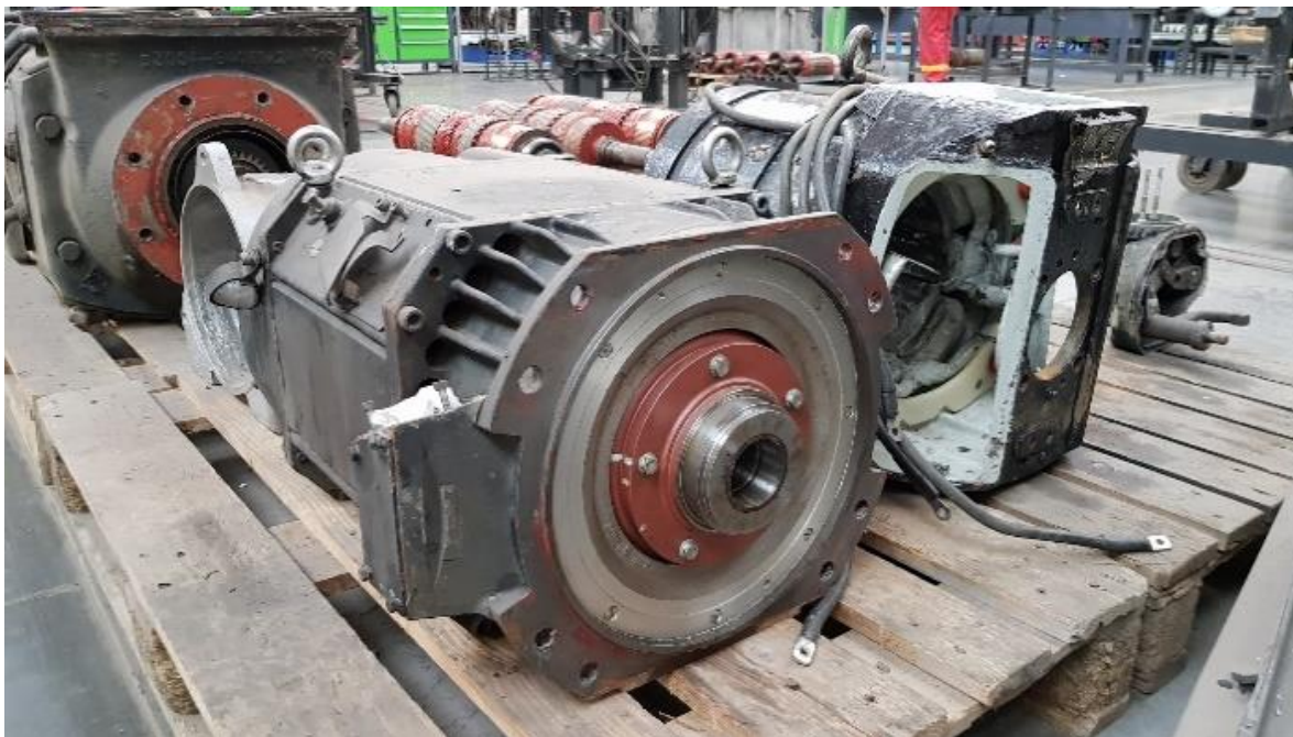
Rys. 3.7. Silnik trakcyjny asynchroniczny Skoda stosowany w omawianym układzie napędowym
