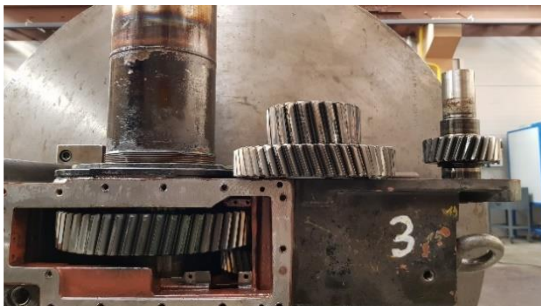
Rys. 3.6. Fragment przekładni Flender stosowanej w omawianym układzie napędowym – koła zębate łączące wał silnika są wewnątrz skrzyni, pozostałe - mniejsze (wymontowane)
