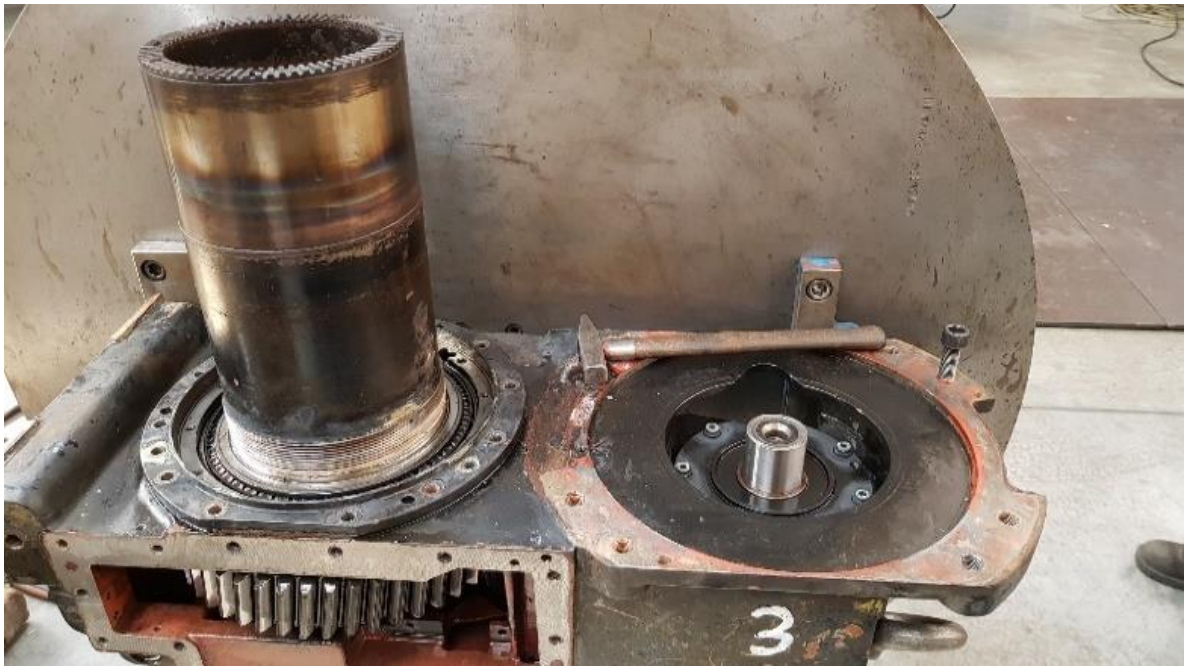
Rys. 3.3. Fragment przekładni Flender stosowanej w omawianym układzie napędowym w obudowie wraz z wałem łączącym z silnikiem trakcyjnym
