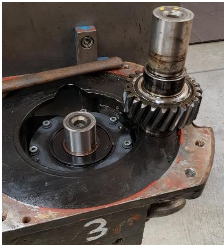
Rys. 3.4. Fragment przekładni Flender stosowanej w omawianym układzie napędowym
