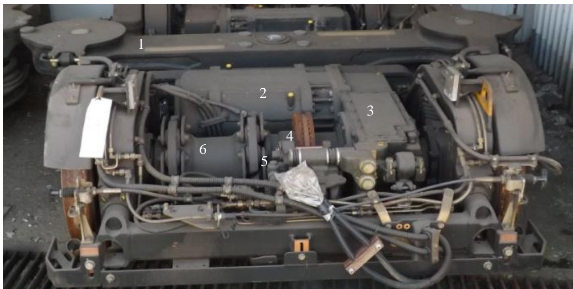
Rys. 1.1. Zdjęcie wózka z widokiem układu napędowego wagonu tramwajowego NGT6 Kr: 1 – ostoja wózka napędowego; 2 – elektryczny silnik trakcyjny; 3 – przekładnia; 4 – wał drażony; 5 – sprzęgło czterociągłowe (FLENDER), 6 – wał pośredni;
