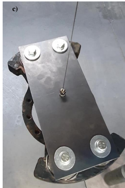
Rys. 3.11. Doświadczalne wyznaczenie masowego momentu bezwładności: a) dla rury badawczej, b) dla środkowej części sprzęgła, c) dla tarczy zabierakowej sprzęgła od strony wału napędowego wychodzącego od przekładni
