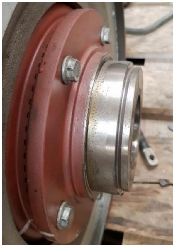
Rys. 3.5. Fragment przekładni Flender stosowanej w omawianym układzie napędowym – wyjście napędu z silnika trakcyjnego
