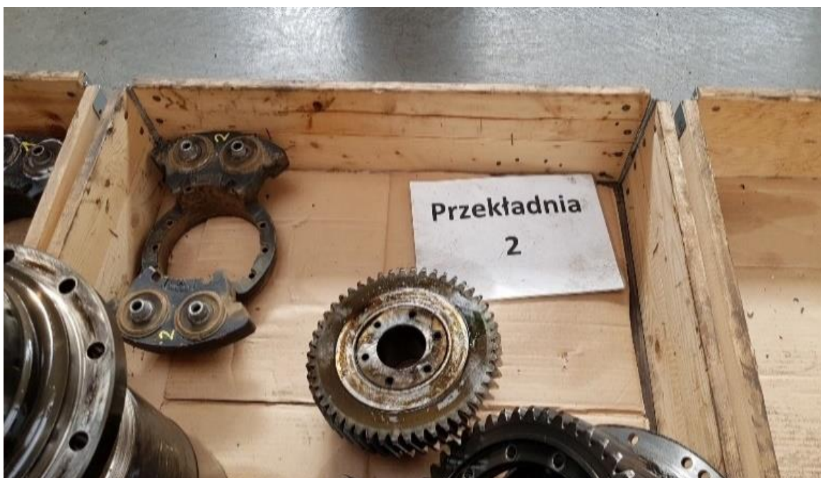
Rys. 3.2. Wymontowane fragmenty sprzęgła i przekładni Flender stosowanej w omawianym układzie napędowym (koła zębate oraz z jedna z tarcz zabieraków)
