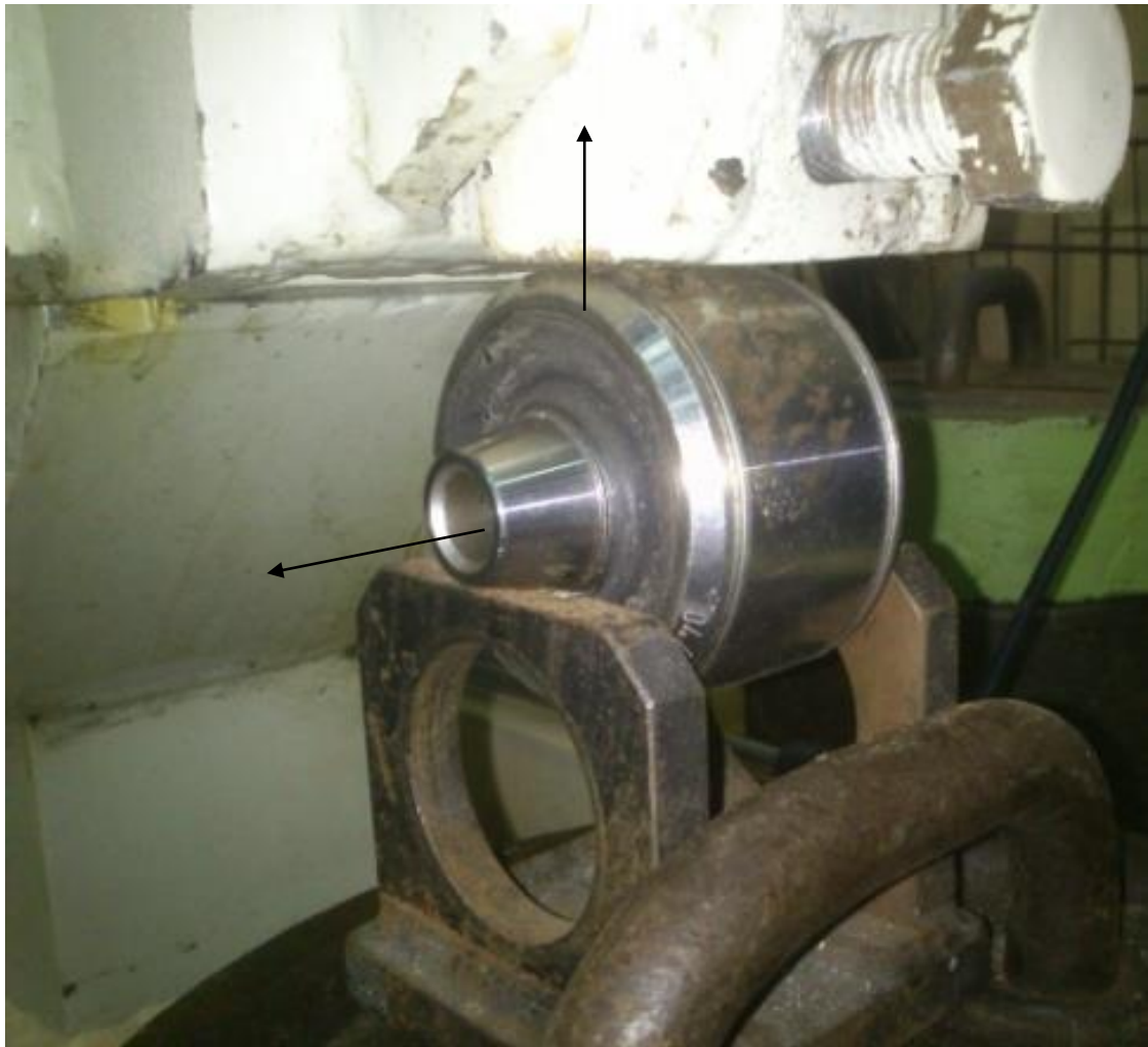
Rys. 9.1. Tuleja metalowo-gumowa - element układu napędowego tramwaju na stanowisku badawczym oraz jej osie: podłużna i promieniowa
