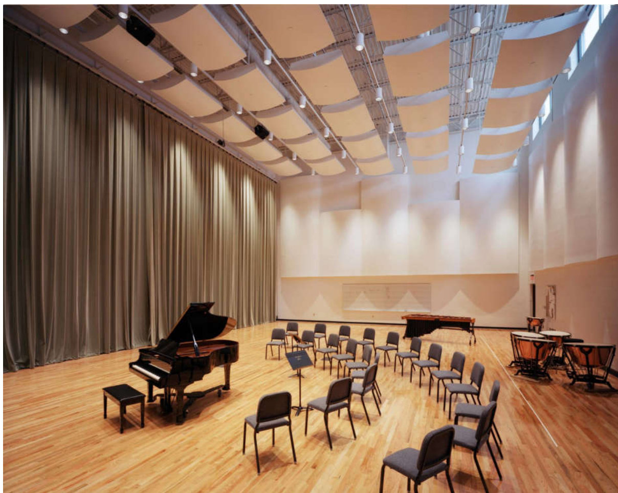
Ilustracja 28. Ingram Center for the Performing Arts, Nashville, USA. Przykład zastosowania kotar wzdłuż jednej z równoległych ścian sali prób w celu uniknięcia niepożądanego efektu echa trzepoczącego. [www.building-ideas.net, dostęp: sierpień 2022]
