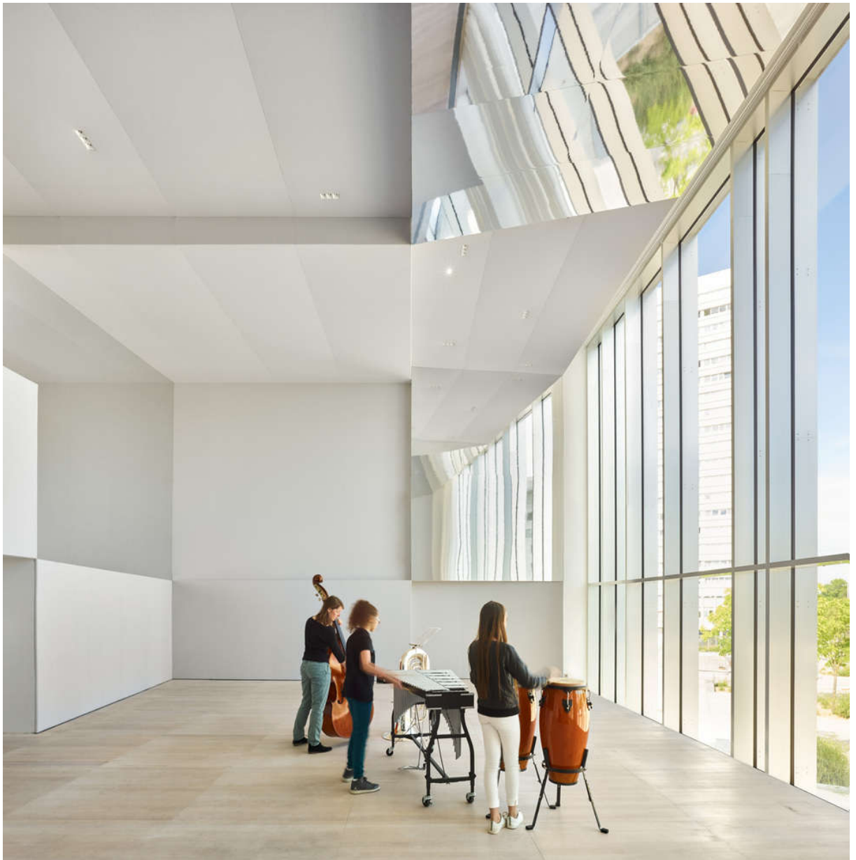
Ilustracja 13. Allende - Performing Arts Center, Mons-en-Baroeul, Francja – sala prób kilkuosobowych zespołów muzycznych, której wymaganą kubaturę osiągnięto dzięki wysokości pomieszczenia ponad 4,5 m. Architektura: Dominique Coulon & Associates. [www.archdaily.com, dostęp: maj 2020, fot.: E.Pons, D. Romero-Uzeda]
