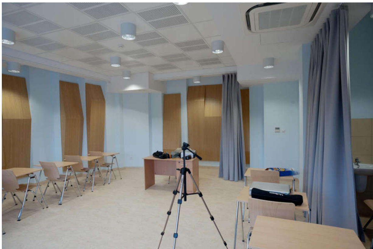
Ilustracja 53. ZPSM im. M. Karłowicza w Krakowie - sala "okrągła" po adaptacji akustycznej. [fot. A.K. Kłosak]
