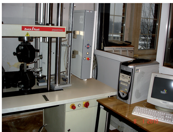
Il. 4. Uniwersalna maszyna wytrzymałościowa UTS 100K/Zwick/Roell w konfiguracji przygotowanej do próby rozciągania. Fot. aut.
