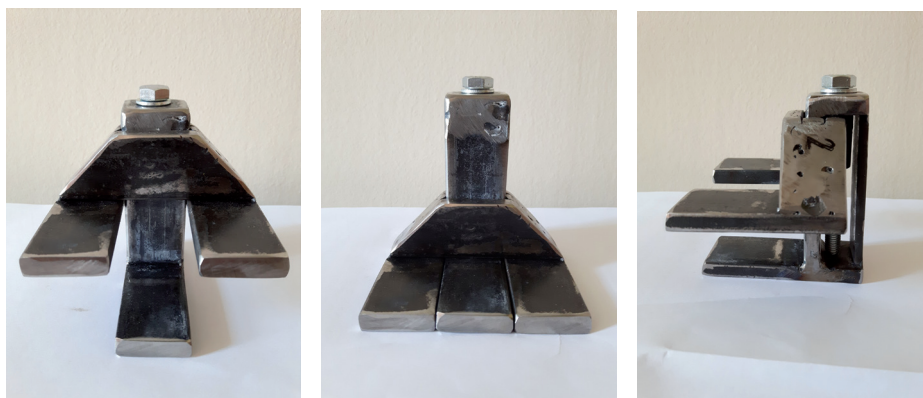
Il. 2. Przyrząd typu PPW1K do podnoszenia okien – widok rzeczywisty. Fot. aut.
