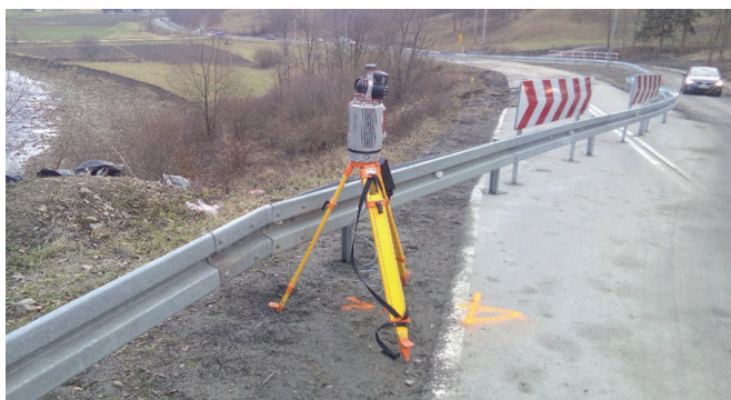
Il. 1. Naziemny skaner laserowy Riegl VZ-400. Fot. E. Pilecka
