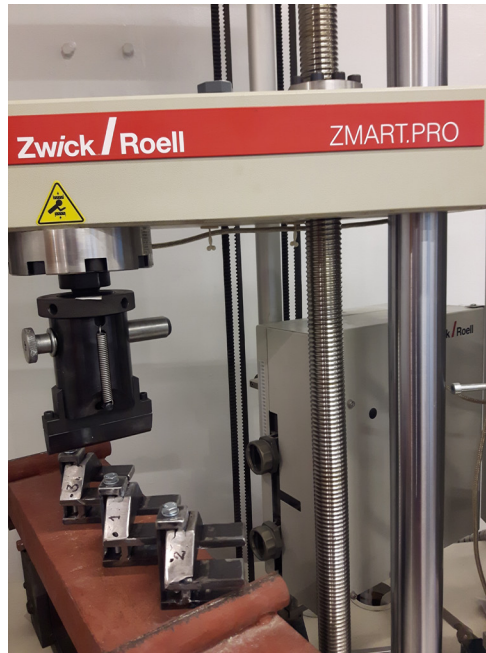
Il. 5. Uniwersalna maszyna wytrzymałościowa UTS 100K/Zwick/Roell wraz z badanymi próbkami w konfiguracji przygotowanej do próby ściskania. Fot. aut.
