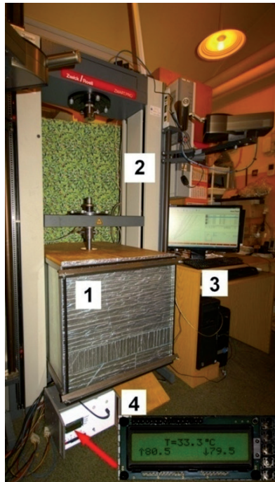
Il. 9. Komora temperaturowa w maszynie wytrzymałościowej Zwick: 1 – komora temperaturowa, 2 – maszyna wytrzymałościowa, 3 – komputer sterujący, 4 – regulator temperatury wraz z zasilaczem. Opracowanie aut. na podstawie [7]
