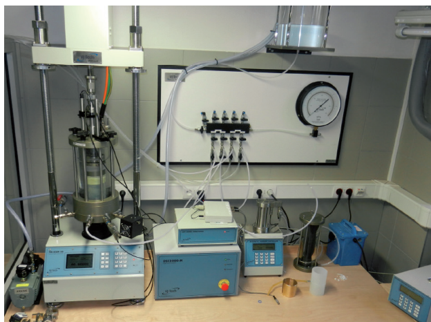
Il. 1. Aparat trójosiowego ściskania. Opracowanie aut.
