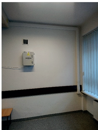
Il. 4. Miernik Looko2 do pomiaru stężenia pyłów zawieszonych wewnątrz sali. Fot. aut.
