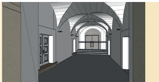
Il. 4. Model budynku siedziby Katedry Historii Architektury i Konserwacji Zabytków Wydziału Architektury Politechniki Krakowskiej, wykonany w technologii HBIM za pomocą chmury punktów, model parteru. Aut. A. Marek, P. Pikulski
