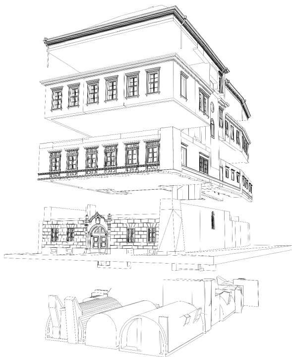
Il. 1. Model budynku siedziby Katedry Historii Architektury i Konserwacji Zabytków Wydziału Architektury Politechniki Krakowskiej, wykonany w technologii HBIM za pomocą chmury punktów, z podziałem na poszczególne kondygnacje. Aut. A. Marek, P. Pikulski
