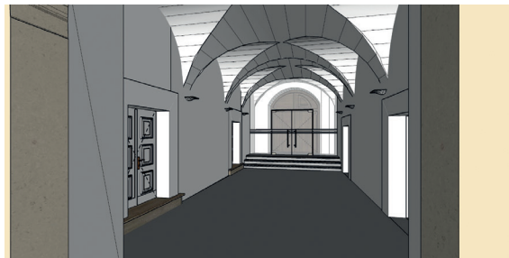
Il. 4. Model budynku siedziby Katedry Historii Architektury i Konserwacji Zabytków Wydziału Architektury Politechniki Krakowskiej, wykonany w technologii HBIM za pomocą chmury punktów, model parteru. Aut. A. Marek, P. Pikulski
