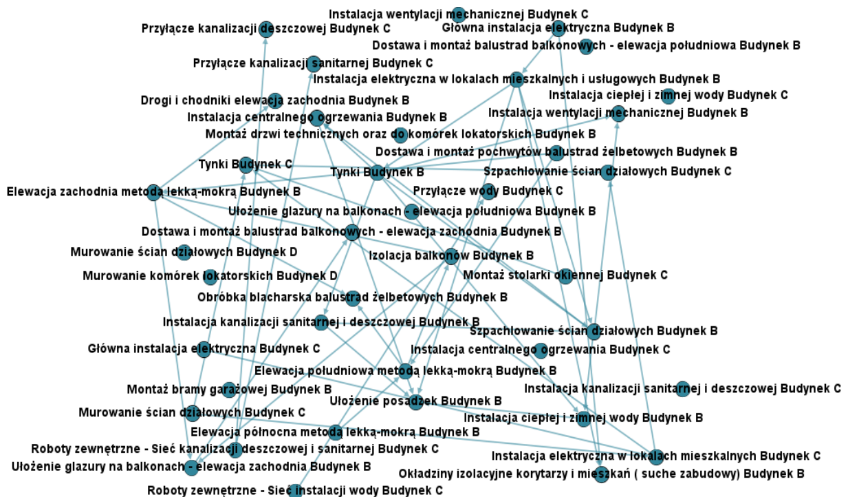
Rys. 29. Sieć przedstawiająca sekwencje wykonywanych zadań (harmonogram robót) w pierwszym miesiącu po reorganizacji. Opracowanie własne
