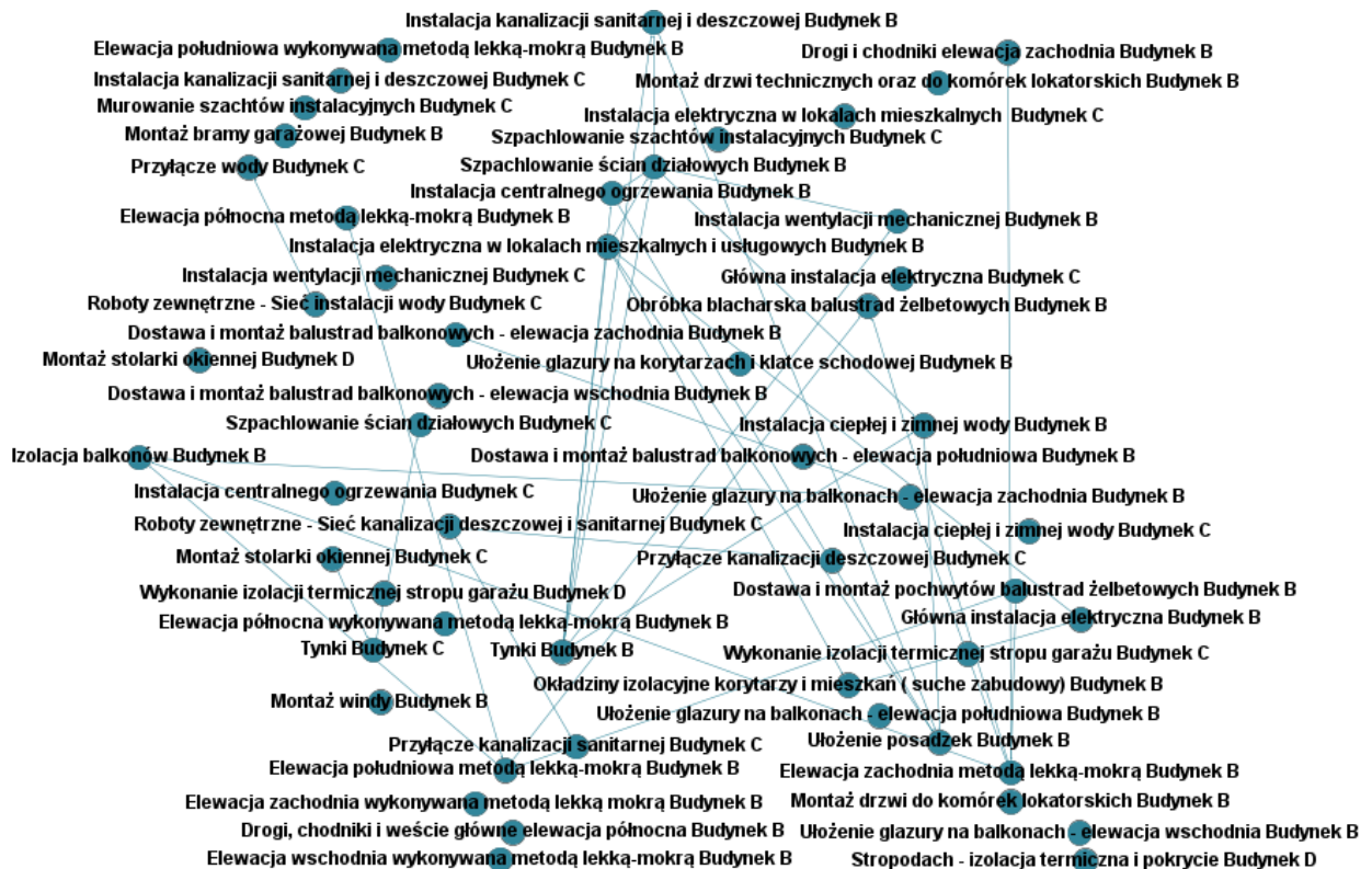
Rys. 33. Sieć przedstawiająca sekwencje wykonywanych zadań (harmonogram robót) w planowanym okresie – drugim miesiącu po reorganizacji. Opracowanie własne
