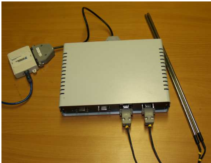
Fig. 6.4. ATU 2001 module with probe holders (Fot. R. Klaput)
