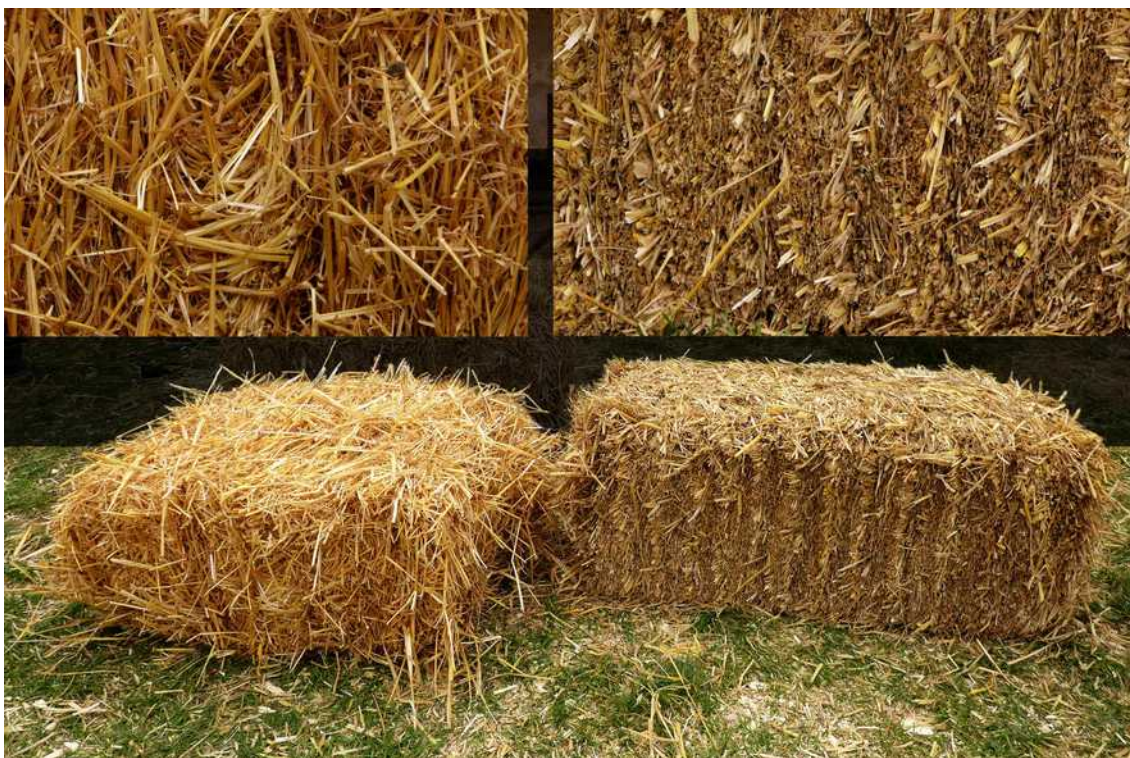
[il. 22] Niezbyt dobrej jakości kostka słomy (po lewej). Dobrej jakości kostka słomy (po prawej). Zbliżenia pokazują strukturę kostek. W kostce po prawej widać podział na płyty, czyli kolejne warstwy zgarniętej i sprasowanej przez kostkarkę słomy. Fot. autor
