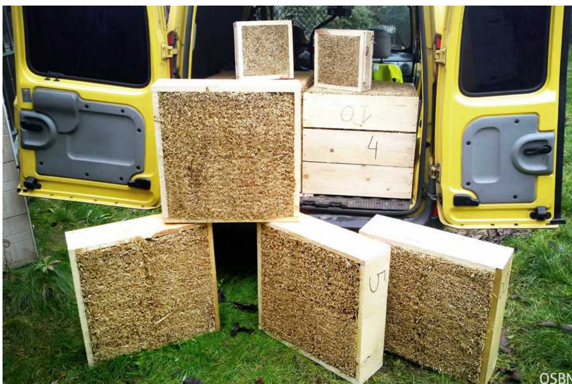
[il. 34] Próbki do badania współczynnika przewodności cieplnej kostek słomy dla przepływu strumienia ciepła wzdłuż źdźbeł (czyli jak dla kostek wbudowywanych na płask). Widać niemal idealne uporządkowanie źdźbeł w próbce. Wykonanie próbek: Moritz Reichert. Fot. Przemysław Woś
