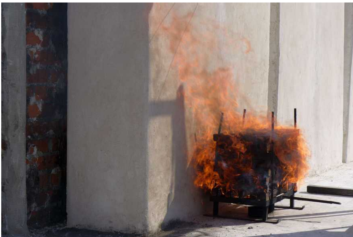
[il. 41] Badanie NRO (nierozprzestrzeniania ognia) ściany z kostek słomy z tynkiem wapiennym. Laboratorium Ignis, Swory, 2017. Fot. autor
