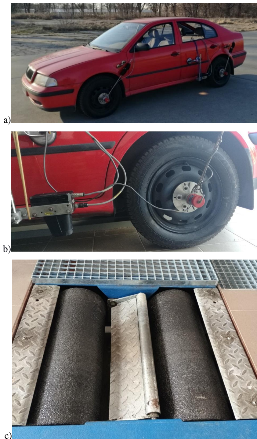
Rys. 12. a) Samochód badawczy Skoda Octavia przygotowany do badań drogowych, b) sposób montażu głowicy optycznej Correvit i czujnika impulsowego prędkości obrotowej koła, c) stanowisko rolkowe do kontroli układów hamulcowych wykorzystywane w badaniach
