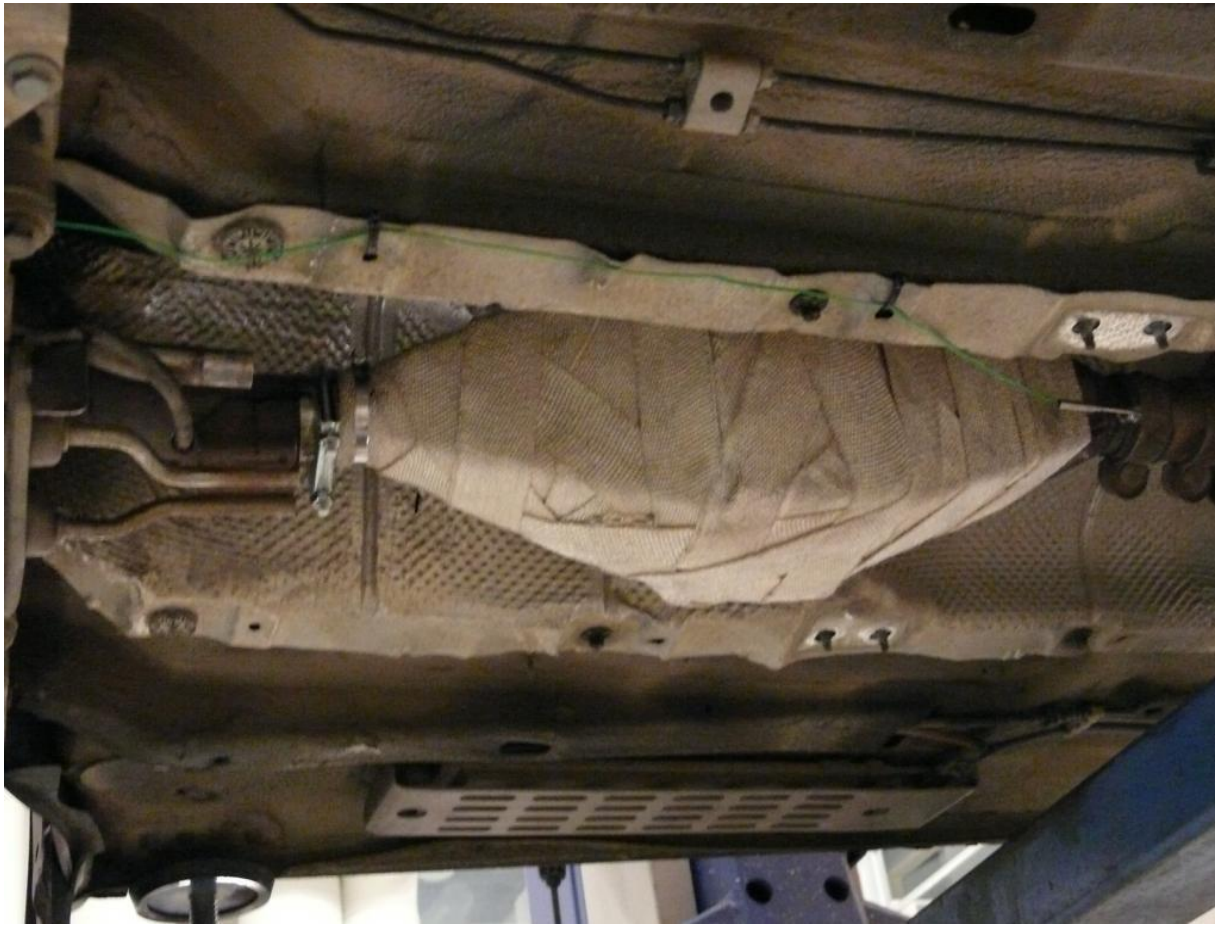
Rys. 2.3. Wymiennik ciepła gazy wylotowe - ciecz chłodząca oraz widoczny czujnik temperatury spalin na wylocie z wymiennika [10]
