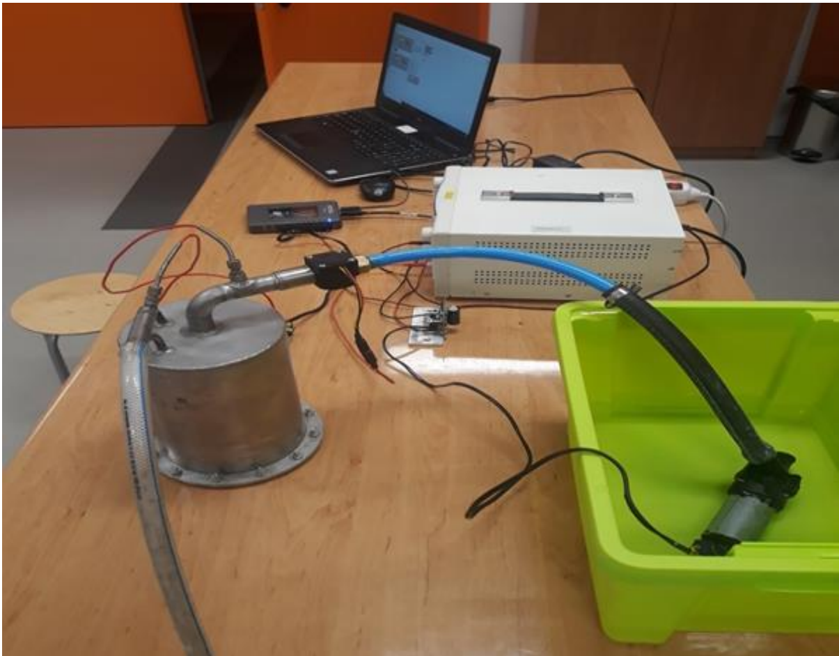
Rys. 7.3. Stanowisko badawcze z akumulatorem ciepła i aparaturą pomiarową
