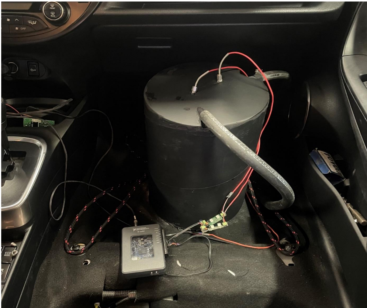
Rys. 7.6. Akumulator ciepła zamontowany w badanym pojeździe
