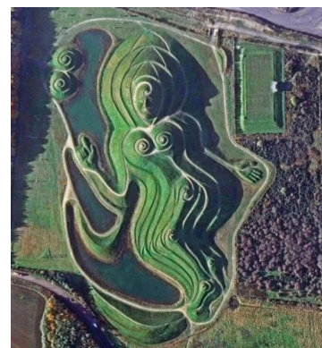
Il. 2.60. Northumberlandia . Zwałowisko zewnętrzne jako bryła krajobrazowa Lady of the North w sąsiedztwie kopalni odkrywkowej węgla Shotton, Anglia (fot. WorldView – 2, 2013).
