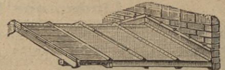
Leistendeckung mit Maueranschluss.
