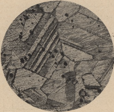
Abb. 1. Messing auf 450^{\circ}\text{C} erwärmt, 75fach vergrößert Aufgenommen in der Photographischen Lehranstalt des Lettevereins zu Berlin
