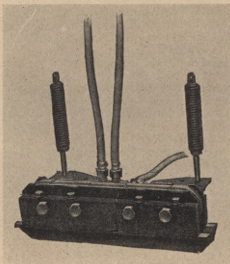
Abb. 4. Außenansicht der elektromagnetischen Schienenbremse
