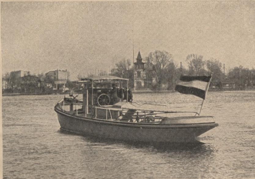
Abb. 1. Akkumulatoren-Schleppboot älterer Bauart mit Dreischraubenantrieb. Motorleistung 65 PS. Bootlänge 17,5 m
