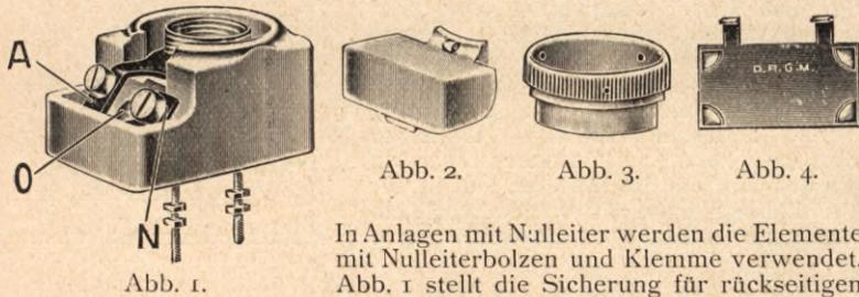
In Anlagen mit Nulleiter werden die Elemente mit Nulleiterbolzen und Klemme verwendet. Abb. 1 stellt die Sicherung für rückseitigen Anschluß, und zwar für einen gesicherten Anschluß, während der Gewinding der Sicherung mit der vorn liegenden Klemme A verbunden ist. Die gleichfalls vorn liegende Klemme N ist für den Nulleiter bestimmt und trägt an der Rückseite einen Anschlußbolzen. Die zwischen den Klemmen A und N
