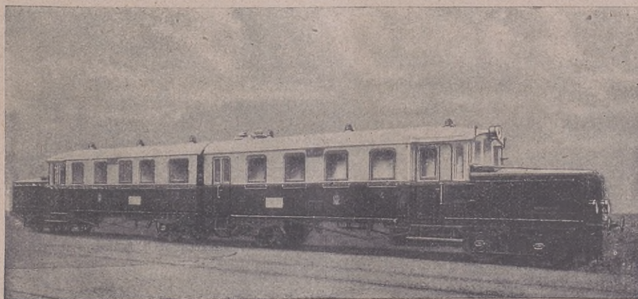
Abb. 1. Akkumulator-Doppelwagen mit Stromrückgewinnung der Königlich Preußischen Staatseisenbahn-Verwaltung
