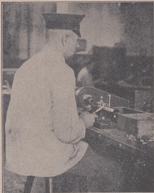
Senken von Teilen an der wagerechten Gewindeschneidemaschine.
