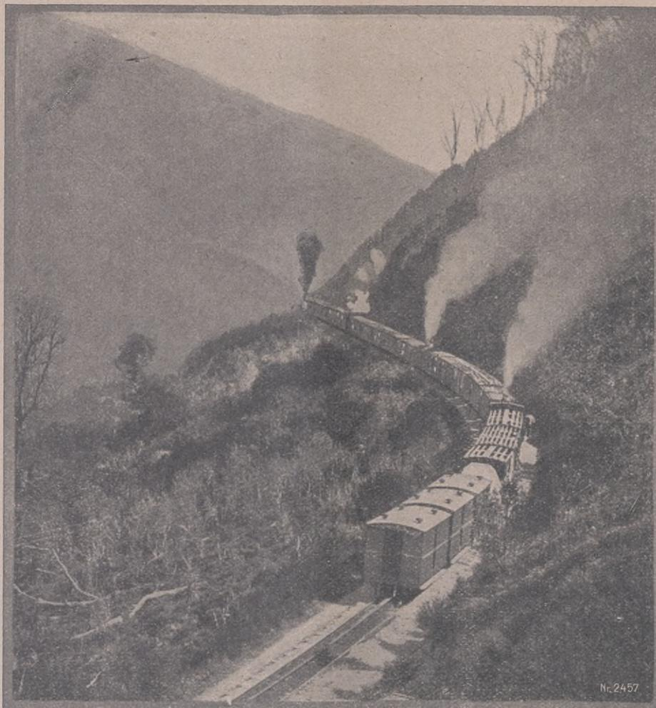
Abb. 6. — Viehzug, von 4 Fell-Lokomotiven gezogen, auf dem Rimutaka-Abhang. (Neuseeland-Regierungsbahn.) Spur: 1067 mm. Steigung 1 : 15 mit zahlreichen 125 m-Kurven. Gewicht des Zuges, ohne Maschinen, 260 Tonnen
