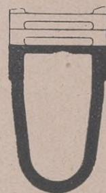
Abb. 4. Querschnitt eines Hohlrostkörpers mit innerer Luft- und Dampfkühlung des Pluto Stokers.
