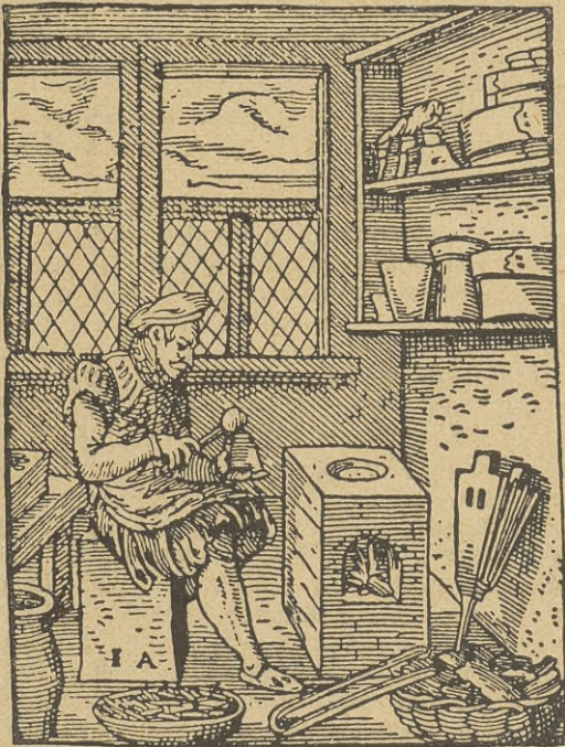
Abb. 1. Gießen von Buchdrucklettern im 15. Jahrhundert
