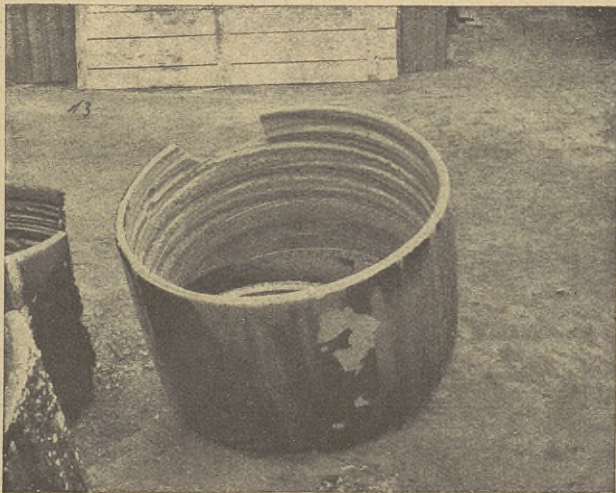
Abb. 1 Hafen für die Glasmass nach zehnwöchigem Gebrauch
