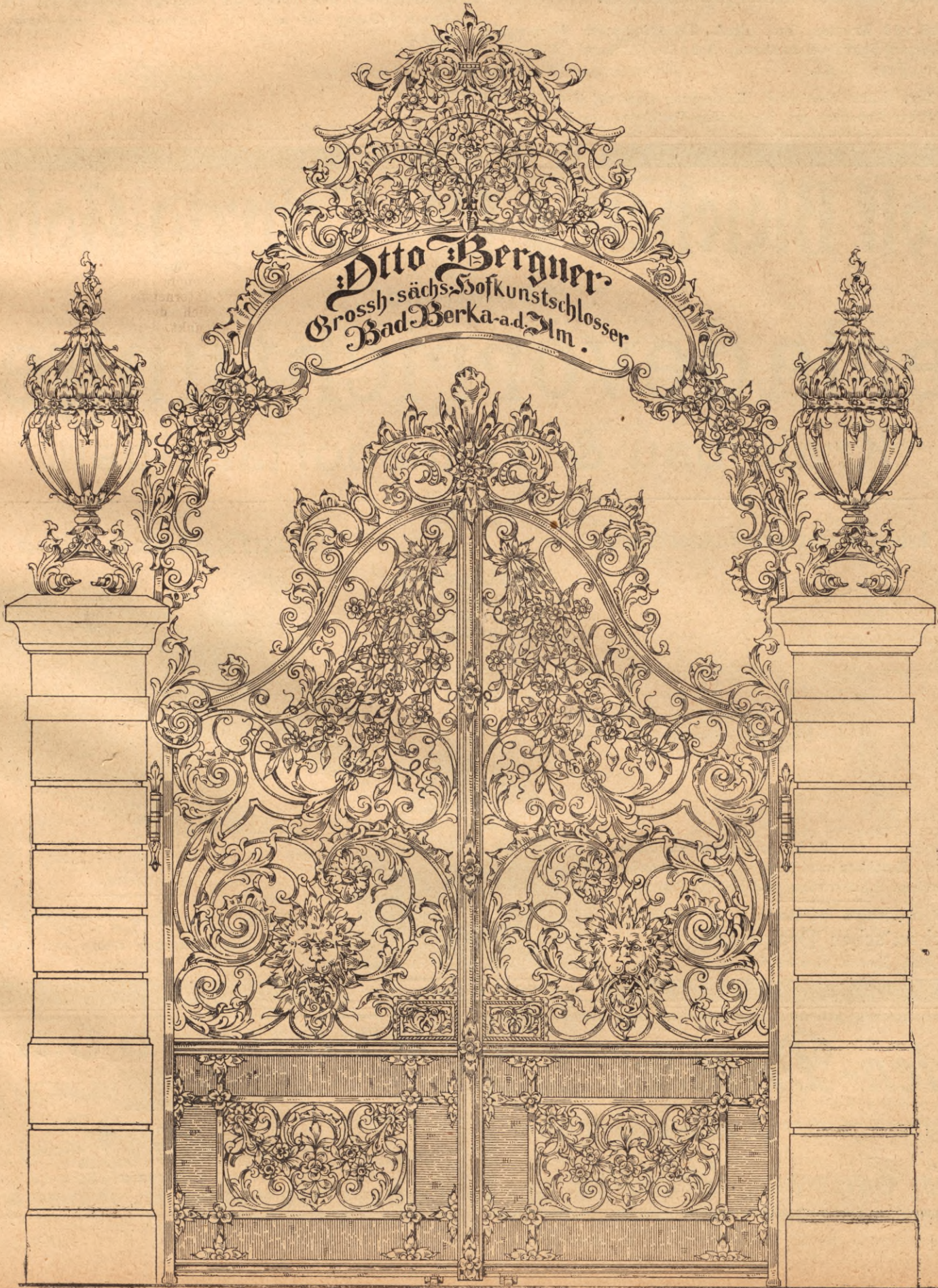
Die inneren Flügel dieses Thores sind 3 m breit und 4 1/2 m hoch und haben ein Gewicht von 1400 kg.
