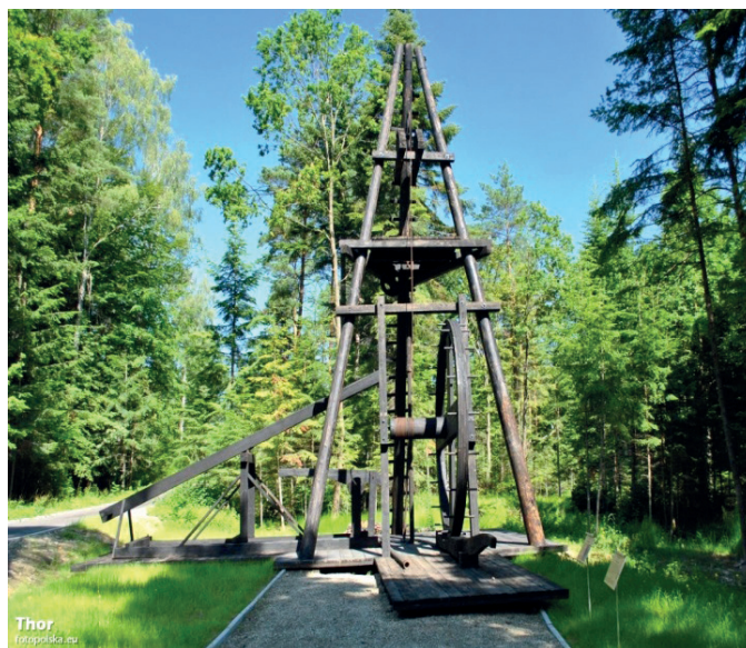
Rys. 3.4. Zrekonstruowana wiertnica ręczna zastosowana w Bóbrce w 1862 roku
