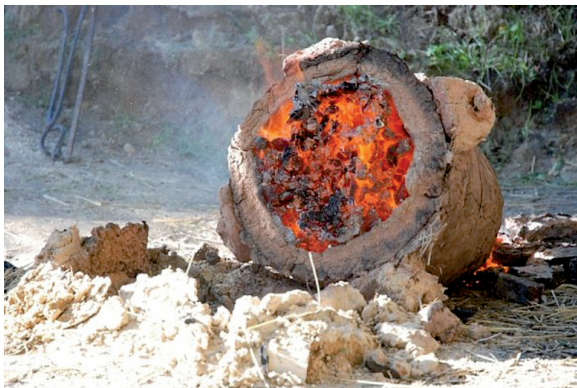
Rys. 30. Rekonstrukcja wytopu żelaza w dymarce
