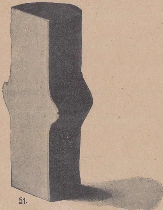
Fig. 1. Schnitt durch ein geschweißtes Stück.
