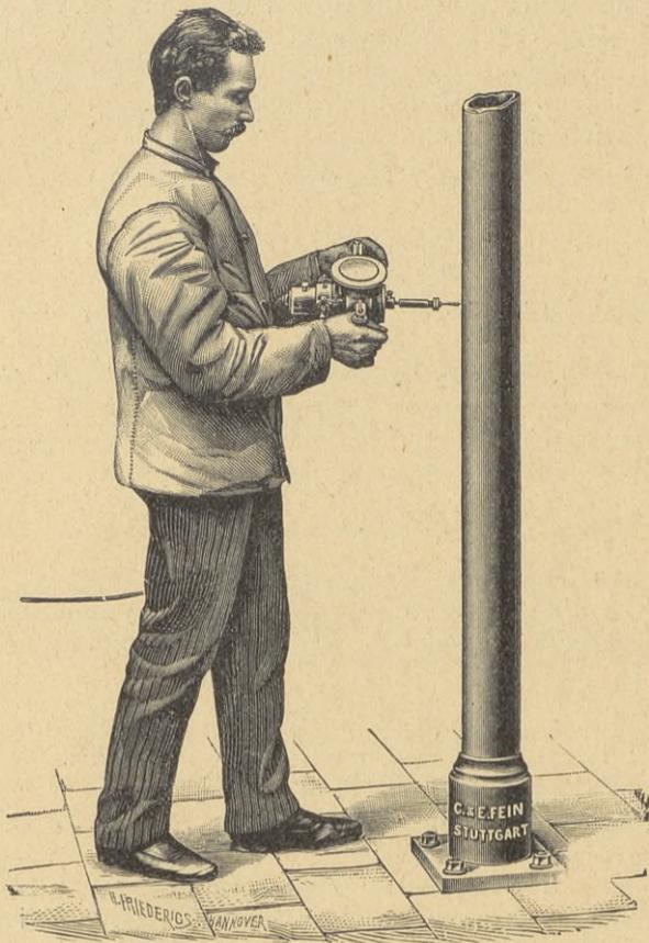
oder dergl. ist der Stromkonsum ein dementsprechend kleiner. Den gewöhnlichen Drillbohrern gegenüber, wie sie seither für dieselben Zwecke von Hand angetrieben wurden, sind diese neuen Apparate, wie leicht einzusehen, weit überlegen und lassen sich mit ihrer Hilfe ganz mühelos in derselben Zeit mehr als fünfmal soviel Bohrungen ausführen.
