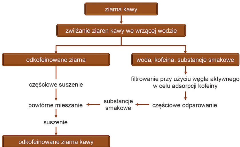
Il. 49. Schemat otrzymywania kawy bezkofeinowej – Szwajcarski Proces Wodny
