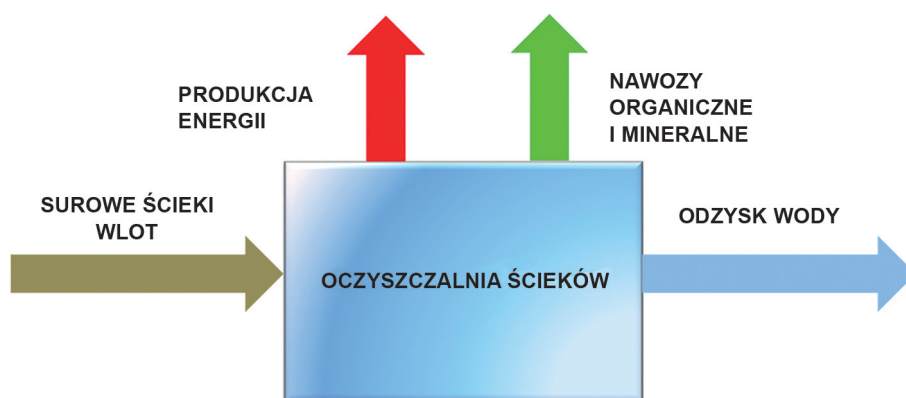
Il. 1.1. Oczyszczalnia ścieków miejskich jako „obiekt odzysku zasobów i energii” (opracowanie własne na podstawie serii publikacji IVL-Stockholm, Szwecja)
