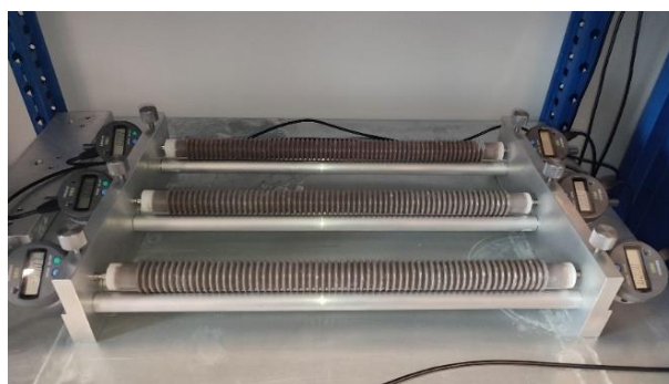
Rys. 6.2 Zestaw do pomiaru skurczu autogenicznego zgodny z ASTM C 1698 [127]
