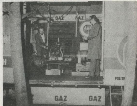
Stanowisko do badań zastosowania gazu ziemnego jako paliwa zastępczego w silnikach o zapłonie iskrowym
