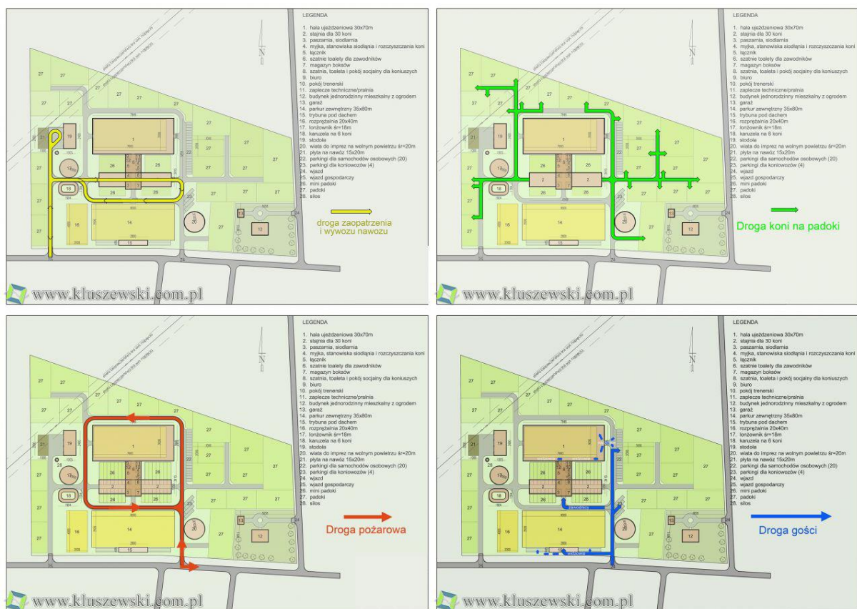
Rycina 2.14 Drogi technologiczne w ośrodku jeździeckim, 115 wg J. Kluszewski. Drogi zaznaczone na kolor żółty – droga zaopatrzenia i wywozu nawozu (obornika), drogi zaznaczone na kolor zielony – droga koni na padoki, drogi zaznaczone na kolor czerwony – droga pożarowa, drogi zaznaczone na kolor niebieski – droga gości
