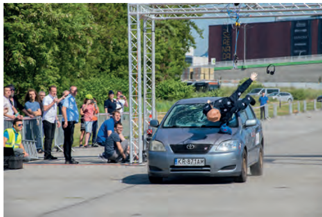
Jeden z kontrolowanych testów zderzeniowych. Fot.: Jan Zych
