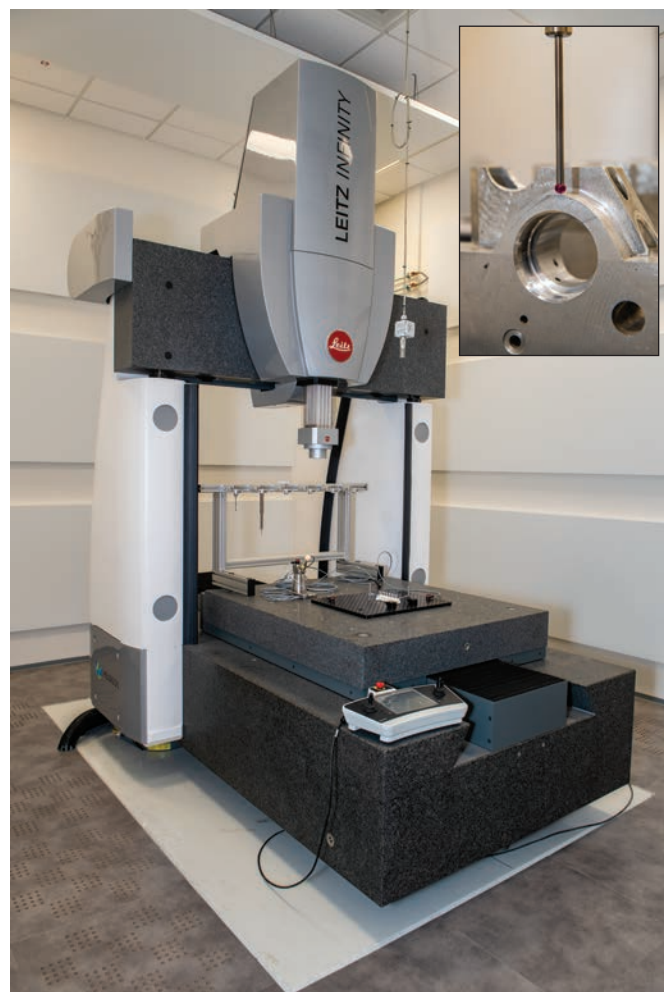
Ultraprecyzyjna współrzędnościowa maszyna pomiarowa Leitz Infinity 12.10.7. Na zdjęciu u góry: Pomiar korpusu silnika spalinowego
