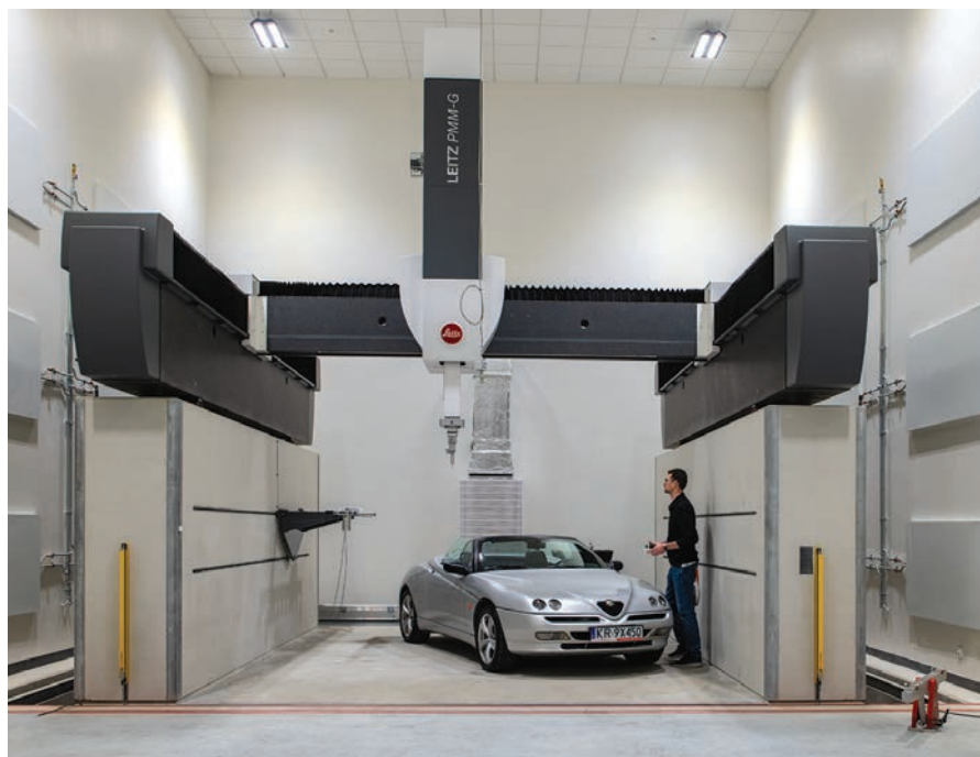
Pomiary karoserii samochodu osobowego na współrzędnościowej maszynie do pomiarów elementów wielkogabarytowych PMM-G 50.30.20 firmy Hexagon
