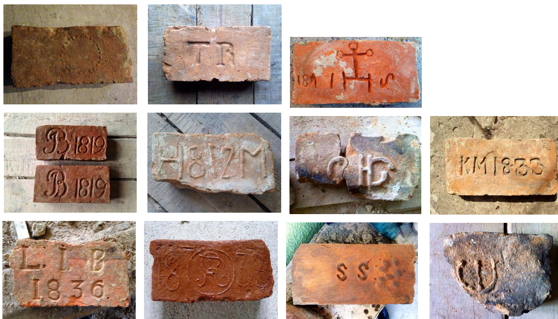
Il. 30. Przykłady hrubieszowskich cegieł. Wypalane cegły często były sygnowane datą, inicjałami wytwórcy lub zamawiającego. Fot. Ł. Krawczyk, lata 2020–2023.
