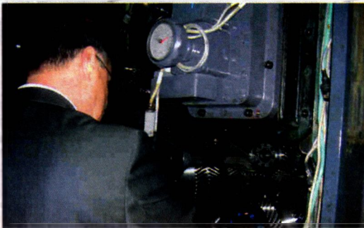
Ekspertyza napędów zębatych (czy to Klingelnberg, Oerlikon, Kurvex, czy Gleason?, to Gleason, bo tylko tą metodą można uzyskać szlifowane zęby łukowe)
