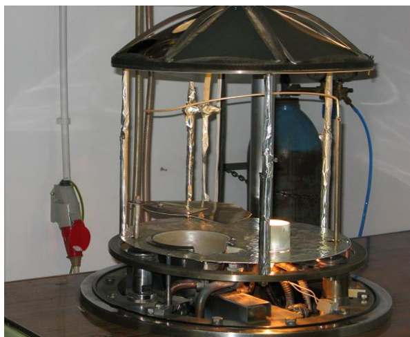
Rys. 51. Działło elektronowe Varian i parownik termiczny
