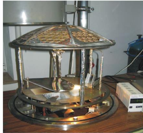
Rys. 84. Obrotowy uchwyt na próbki ze szkła kwarcowego HPFS o średnicy \varphi = 22,3 mm
