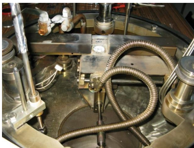
Rys. 76. Wielotyglowe działo elektronowe firmy Varian-H oraz źródło oporowe z tzw. łódką
