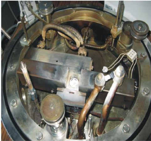
Rys. 83. Działo elektronowe Varian oraz źródło oporowe wyposażone w łódkę tantalową
